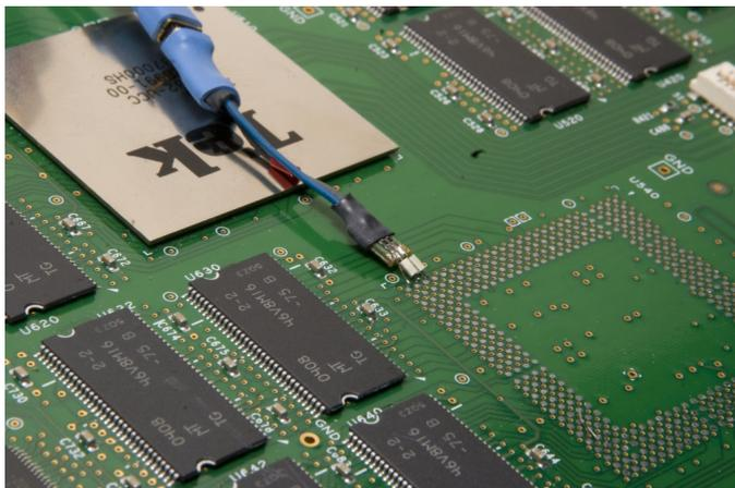
Die kostengünstigen Lötspitzen der P7500 TriMode™-Tastköpfe ermöglichen schnelle Anschlüsse. Daher können die Tastköpfe schnell und einfach zu den Lötstellen bewegt werden.
