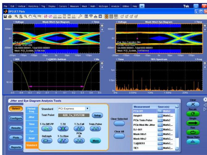
**PCI Express® Sender Fehlerbeseitigung und Konformitätstest (Option PCE3)** – Analysieren Sie die Leistungsfähigkeit Ihres PCI Express® Rev 1.0-, 2.0- oder 3.0- Designs (Draft spec) mit umfassender Testunterstützung. In Verbindung mit DPOJET ermöglicht die Option PCE3 die Durchführung von Tests, die PCI-SIG-Spezifikationen erfüllen.
