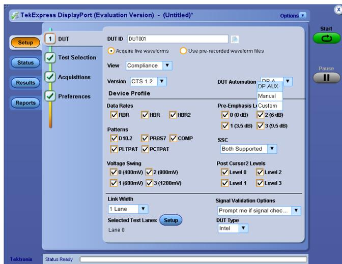
**Software für DisplayPort-Konformitätstest (Option DP12)** – Unterstützt den Quellentest gemäß dem DisplayPort-Standard für Konformitätstests mit simultanen Tests auf vier Leitungen unter Verwendung von Tektronix® Tastköpfen der P7300SMA-Serie und DisplayPort-Software. Detaillierte Testberichte mit Signalardarstellungen, Pass-Fail-Ergebnissen und Grenzwertanalyse sind enthalten.
