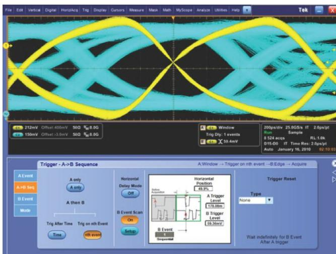
Verwendung eines Triggers mit B-Ereignisabtastung an DDR DQS-Flanken, um ein Augendiagramm aus allen Bits in einem Burst zu erstellen.
