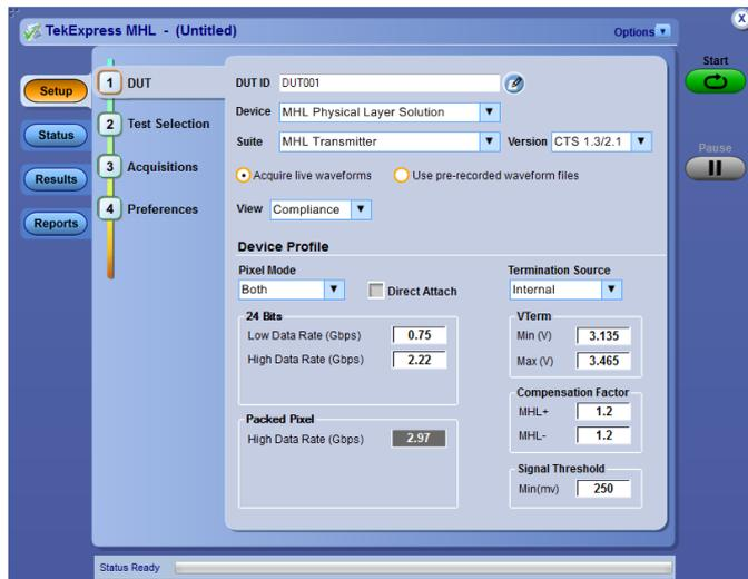
**TekExpress® MHL Software für erweiterte Analyse und Konformitätstests (Option MHD)** – Bietet die umfassendste Lösung für MHL 1.0/2.0/1.3/2.1-Konformitätstests sowie für Fehlerbeseitigung und Validierung von MHL-Geräten anhand der aktuellsten MHL-Spezifikationen. Die Anwendung automatisiert elektrische Sender-, Senken- und Dongle-Tests. Ergebnisse werden in einem umfangreichen HTML-Format für technische Prüfdokumentation dargestellt.
