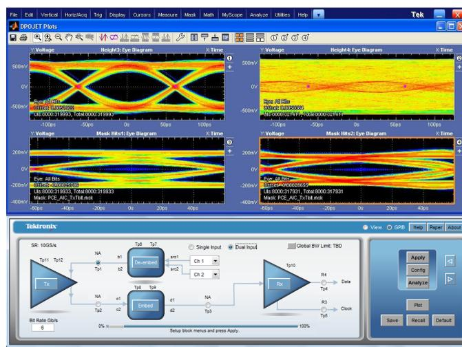
**SDLA – Serial Data Link Analysis Visualizer (Option SDLA64)** – Bietet die Möglichkeit zum Emulieren serieller Datenkanäle, zum De-embedding von Vorrichtungen, Kabeln oder Tastköpfen und zum Hinzufügen oder Entfernen von Entzerrung. Option SDLA64 ermöglicht außerdem die Verarbeitung von Signalen mit IBIS-AMI-Empfänger-Entzerrung oder CTLE-, FFE- und/oder DFE-Entzerrung. DPOJET ermöglicht die erweiterte Messung und Jitter-Analyse des resultierenden Signals.
