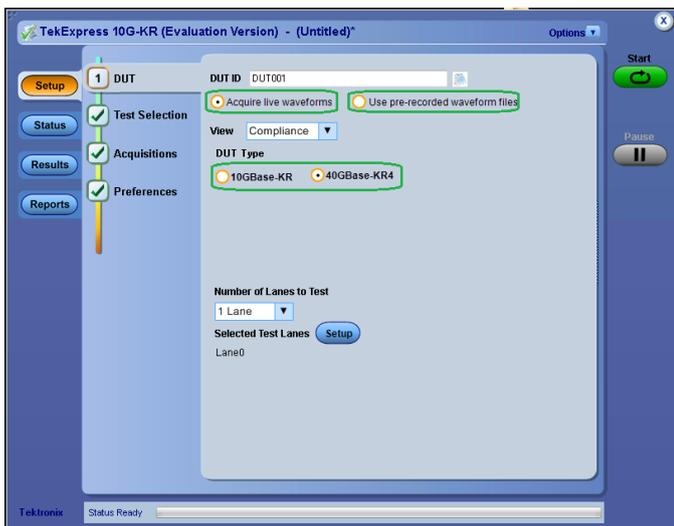
**10GBASE-KR/KR4 Software für Konformitätstests und Fehlerbereinigung (Option 10G-KR)** – automatisierte Konformitätsmessungen für die Spezifikationen IEEE 802.3ap-2007. Diese Option umfasst eine automatisierte Lösung für Konformitätstests und Fehlerbereinigung in Verbindung mit DPOJET. Die automatisierten Testeinstellungen messen Sender-Entzerrungspegel und generieren 12 Ergebnisse für jeden Tap sowie 120 Ergebnisse für 9 verschiedene Messungen in ungefähr 15 Minuten.
