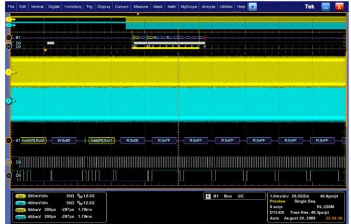
10 ms lange Erfassung von synchronen Hoch- und Niedriggeschwindigkeitssignalen mit 25 GS/s.
