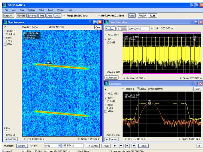
**SignalVu® Vektorsignalanalyse**– Zum einfachen Testen von Breitband-Designs, wie Breitband-Radarsystemen, Satellitenverbindungen mit hohen Datenübertragungsraten, WLAN 802.11 oder Frequenzsprung-Funkanlagen, sowie zur Charakterisierung von Breitband-Spektralereignissen. SignalVu® vereint die Funktionalität eines Vektorsignalanalysators und eines Spektrumanalysators sowie die leistungsstarken Triggerfunktionen der MSO/DPO70000-Serie in einem einzigen Paket.
