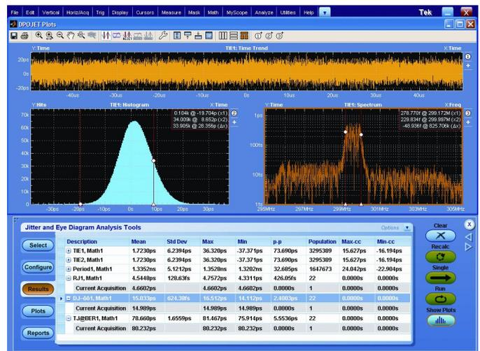
DPOJET Jitter- und Augendiagrammanalyse – Einfachere Identifizierung von Problemen mit der Signalintegrität, Jitter und den zugehörigen Quellen mit der DPOJET-Software. DPOJET bietet die höchste Empfindlichkeit und Genauigkeit, die für Echtzeit-Oszilloskope verfügbar ist.
