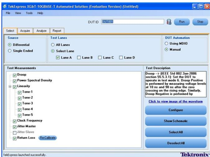
**XGbT 10GBASE-T Software für automatisierte Konformitätstests** – Schnelle Durchführung von 10GBASE-T-Messungen nach dem Standard IEEE 802.3ap-2006, einschließlich spektraler Leistungsdichte (PSD), Leistungspegel und Linearität, bei vereinfachter Gerätekonfiguration. XGbT bietet eine flexible Steuerung der Testkonfigurationen und Analyseparameter und ermöglicht dadurch eine detailliertere Gerätecharakterisierung.
