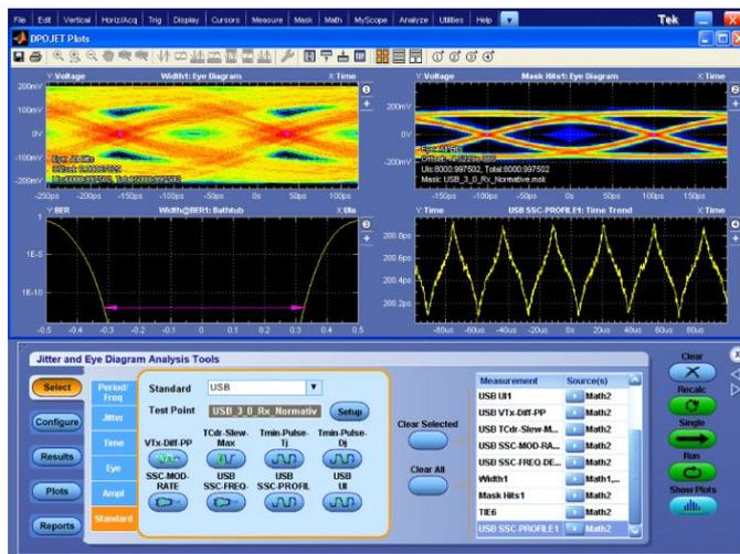
**USB 3.0-Sender-Testsoftware (Option USB3)** – Zur Prüfung, Charakterisierung und Fehlerbereinigung von USB 3.0-Geräten. Messungen werden in DPOJET durchgeführt und entsprechen der USB 3.0-Spezifikation. Zu Konformitäts- und Automatisierungszwecken ist USB-TX verfügbar.
