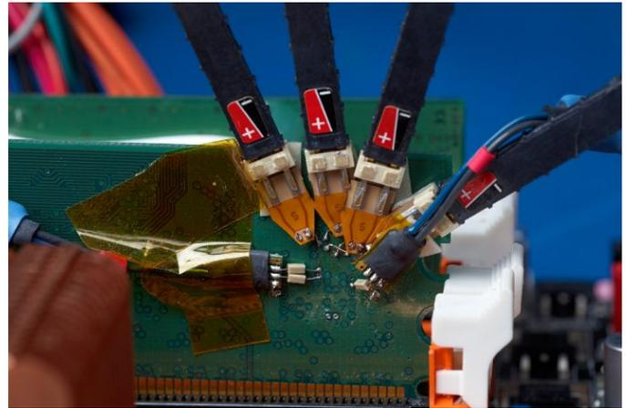
Speziell für die Differential-Logiktastköpfe P6780 entwickeltes Lötspitzenzubehör ermöglicht den Zugang zu Signalen auf engen Durchkontaktierungen und Feinanschlusskomponenten.
