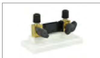
207030500 : 0.001 ohm shunt, 0.5%, 50A max
