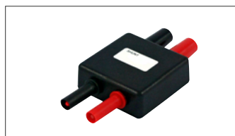
910007100 : 0.01 ohm shunt, 1%, 3A max
