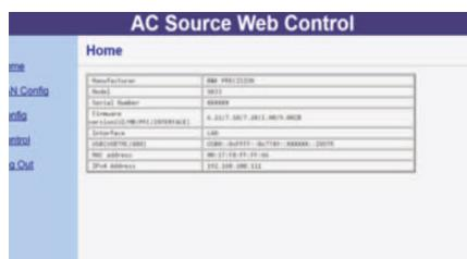
Serveur Web intégré qui permet aux utilisateurs de configurer, contrôler ou surveiller les paramètres de base de la source à partir d'un ordinateur distant à l'aide d'un navigateur Web.
