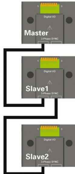
Les adaptateurs TL983P se connectent au connecteur d'E/S numérique à l'arrière de la source AC. Des câbles de communication RJ45 standard connectent chaque adaptateur pour acheminer le signal de synchronisation triphasé du maître vers les unités esclaves.
