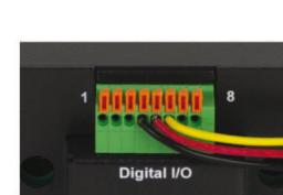
Le bornier d'E/S numérique à 8 broches préserve les broches de signalisation couramment utilisées, y compris les capacités d'inhibition à distance, d'activation du courant alternatif et de sortie de défaut en fonctionnement triphasé.
