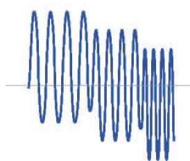
La série BK9830B est capable de générer des formes d'ondes AC + DC. Lorsque vous utilisez le mode impulsion, marche et liste, le signal AC peut être combiné avec une tension continue positive ou négative, ce qui permet aux utilisateurs de créer une large gamme de formes d'onde.
