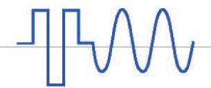
Le mode liste permet de générer des séquences complexes avec un temps, une amplitude, une fréquence et une tension variables. Jusqu'à 100 étapes dans 10 programmes peuvent être sauvegardés et exécutés. Cela permet à l'utilisateur de créer un large éventail de formes d'onde pour simuler les défauts et perturbations du réseau électrique.
