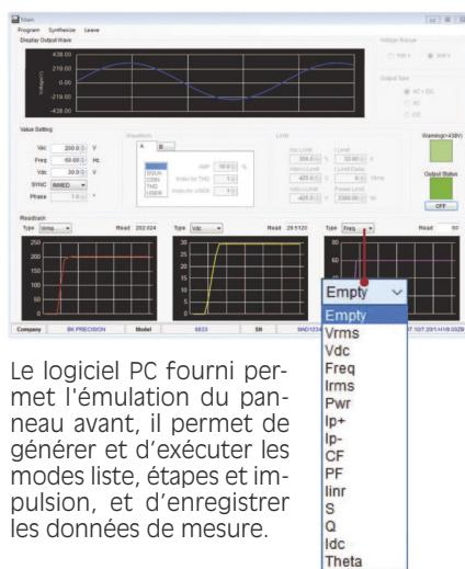
Le logiciel PC fourni permet l'émulation du panneau avant, il permet de générer et d'exécuter les modes liste, étapes et impulsion, et d'enregistrer les données de mesure.
