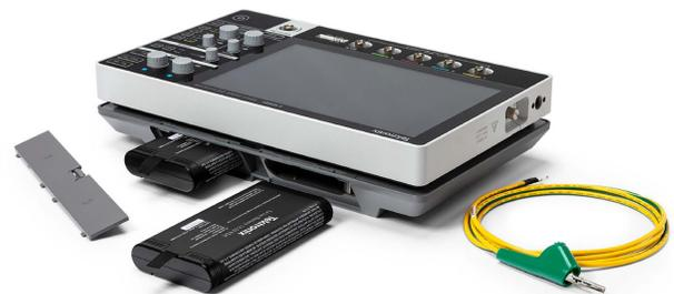
Le bloc-batterie, doté de deux emplacements de batterie, peut être monté à l'arrière de l'instrument
