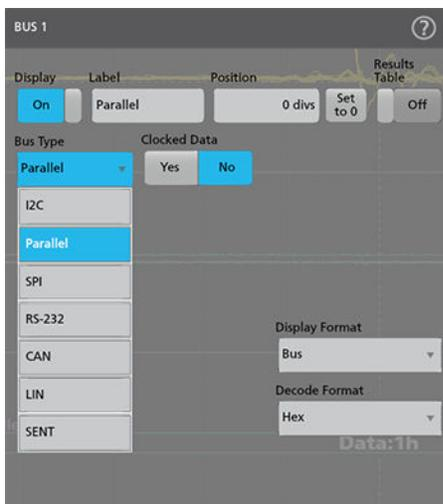
Le menu Bus fournit des options permettant de configurer les paramètres de bus
