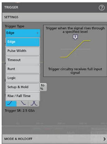
Pour accéder aux menus de configuration, il vous suffit d'appuyer deux fois sur l'élément souhaité. Ici, l'utilisateur a appuyé sur la vignette Déclenchement pour ouvrir le menu de configuration du déclenchement
