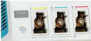
Die FlexChannel-Technologie bietet das Optimum an Flexibilität. Jeder Eingang kann je nach angeschlossenem Tastkopf als ein einzelner analoger oder als acht digitale Kanäle konfiguriert werden.
