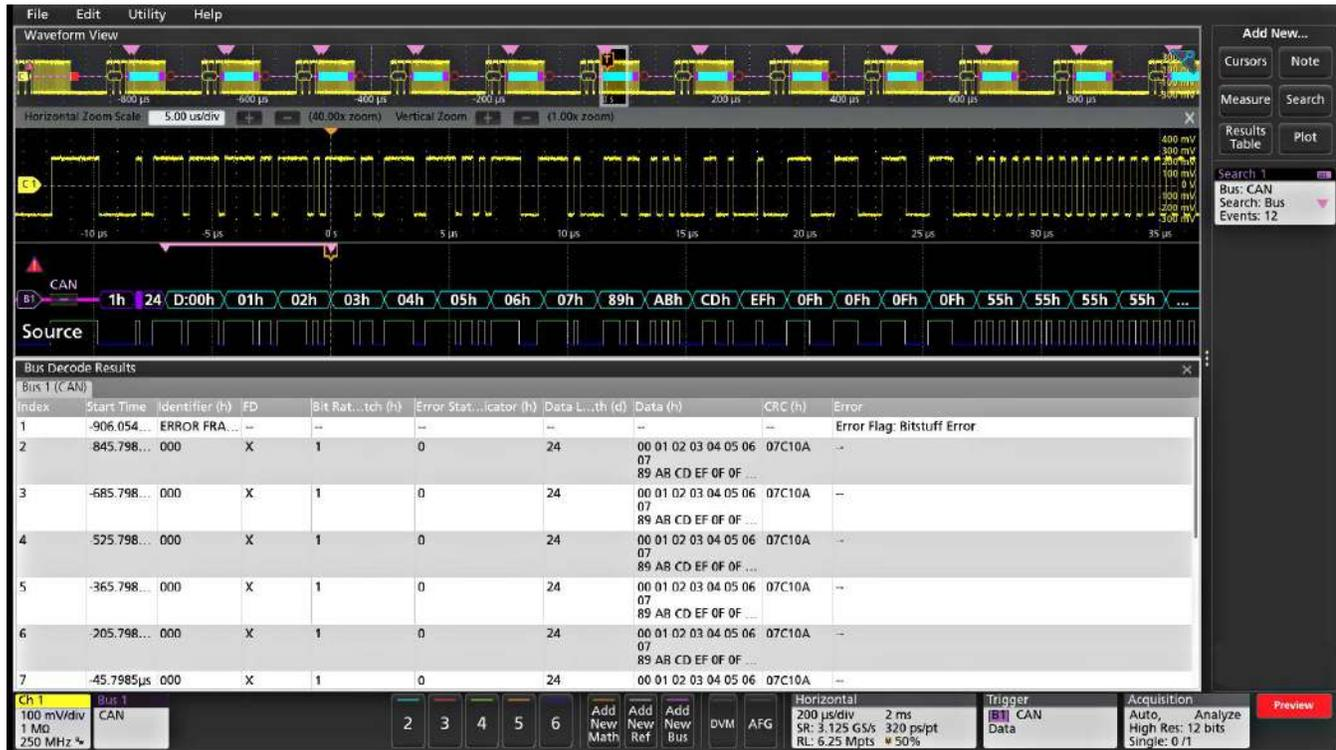
Triggern an einem seriellen CAN-Bus. Ein Bussignal umfasst den zeitkorrelierten decodierten Paketinhalt, einschließlich Beginn, Arbitration, Steuerung, Daten, CRC und ASK, während die Bus-Decodiertabelle alle Paketinhalte aus der gesamten Erfassung angibt.
